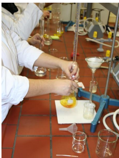
Slika 6: Titracija se zaradi enostavnosti postopka pogosto uporablja v analizi živil (Vir: lasten)
