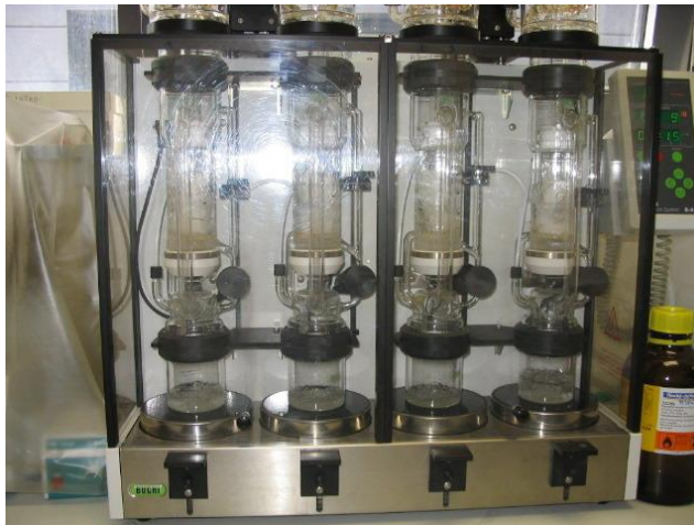
Slika 18: Sodobna naprava za določanje količine maščob po Soxhletu
