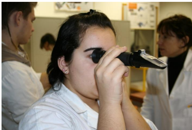
Slika 8: Instrumentalne metode so lahko zelo enostavne – kot je uporaba ročnega refraktometra
