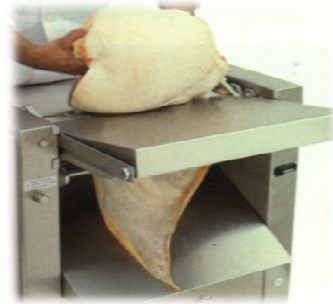
Slika 33: Stroj za odstranjevanje kože s slanine (MAJA-Maschinenfabrik)
