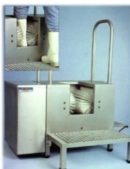
Slika 34: Stroj za pranje škornjev (Nieros)
