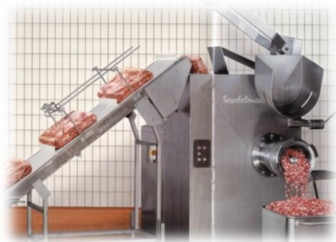
Slika 2: Stroj za mletje zamrznjenega mesa (Seydelman)
