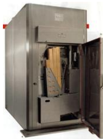
Slika 17: Prekajevalna komora – generator za pridobivanje dima (Maurer)
