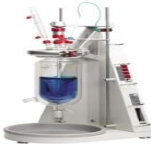
Slika 4: Avtomatski laboratorijski bioreaktor Lara
