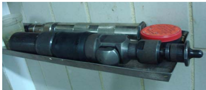
Slika 14: Strelna naprava s penetrirnim klinom in rezervna oprema
