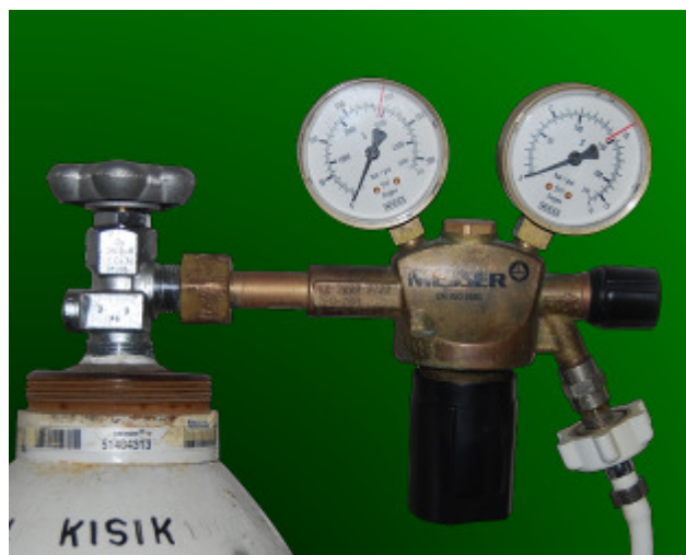
Slika 6: Manometra in redukcijski ventil pri jeklenki s kisikom
