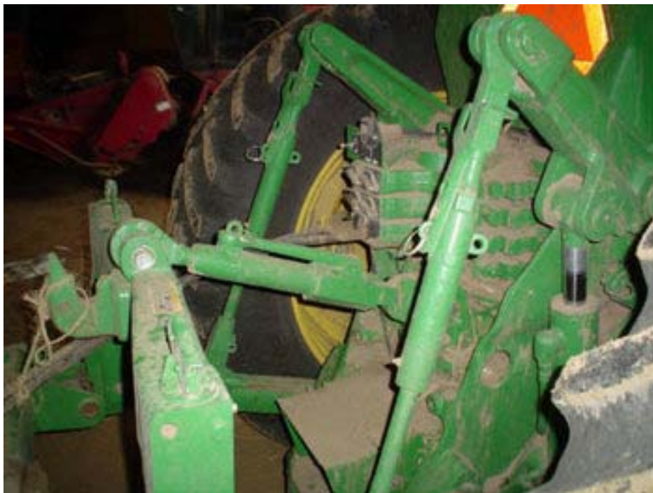
Slika 22 Tritočkovni hidravlični sistem Lasten vir
