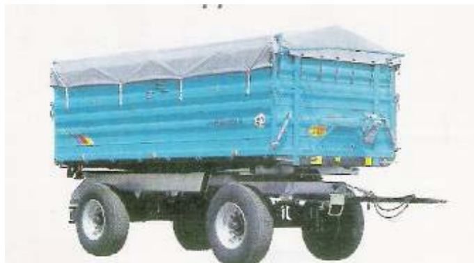
Slika 50 Pravilno opremljena dvoosna prikolica (Vir:lasten vir)
