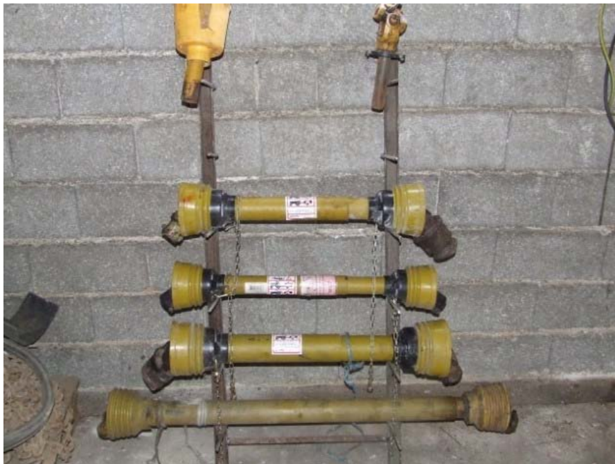
Slika 21 Pravilno zaščitena kardanska gred Vir: traktor.mojforum.si
