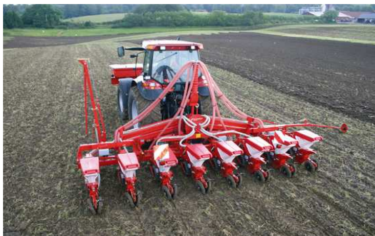
Slika 6.1: Sejalnik za širokovrstno setev (Vir: www.interexport.si , 19.2.2011)
