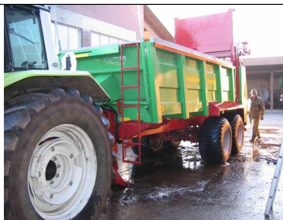
Gnojila zelo agresivno delujejo na kovine, zato je natančno čiščenje strojev za gnojenje zelo pomembno.
