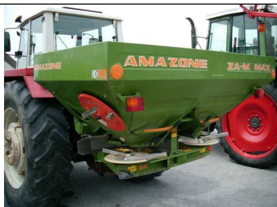
Centrifugalni (ploščni) trosilnik mineralnih gnojil z dvema ploščama
