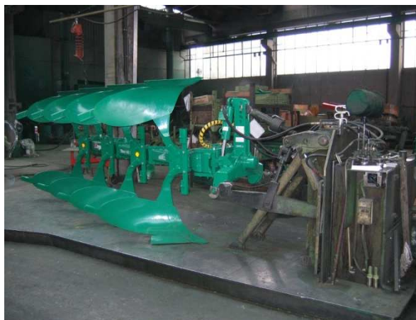
Preizkušanje obračalnega pluga po končanem sestavljanju in barvanju
