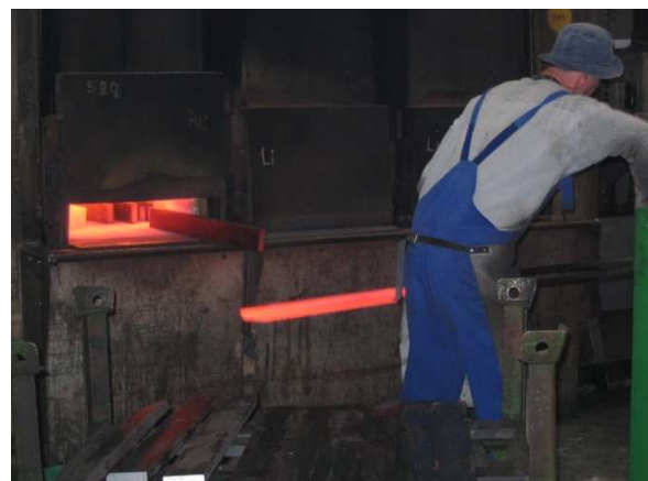
Faza kaljenja – segrevanje gredlja pluga v peči. Sledi ukrivljanje in ohlajanje.
