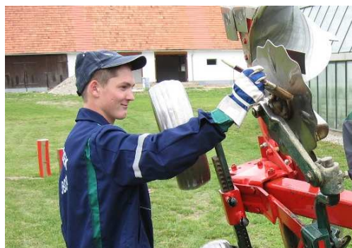
Nanašanje mastnega premaza Pod stroj položimo folijo, da preprečimo onesnaževanje tal.
