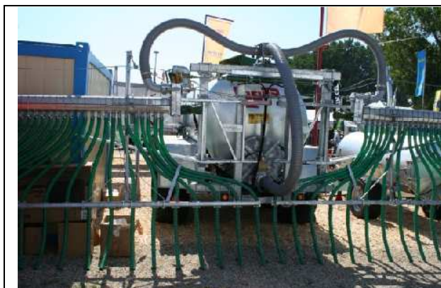
Cisterna za gnojevko z razdelilnimi cevmi za injiciranje gnojevke na tla
